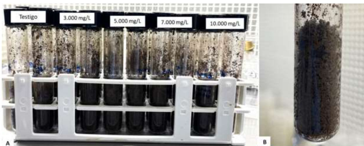
Figura 4. A. Tubos de ensayo con suelo estéril, inoculados con la bacteria y aplicados con el tratamiento respectivo. B. Nótase la humedad del suelo después de haberse aplicado el tratamiento.
